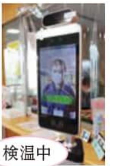
来荘者へは、検温と手指消毒、マスクの着用、来荘票の記入をお願いしています。新しく導入したAI検温モニタ「KAOIRO」では、非接触・短時間で自動検温ができ、高熱が検知されるとアラーム音で知らせてくれます。マスクの着用を促すアナウンスも流れます。
